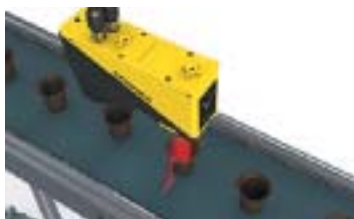
РИС. 10. ◀ Проверка литых под давлением стоек. Система получает эталон профиля емкости и путем сравнения с образцом идентифицирует брак
