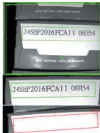
РИС. 4. ▶ Проверка целостности и нанесения в нужном месте напечатанных кодов и других элементов упаковки
